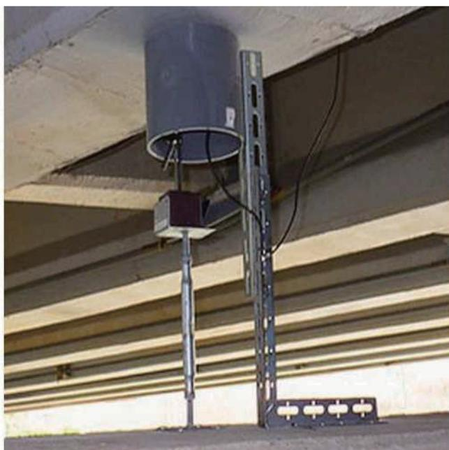
IoT技術を使ったモニタリングシステム。桁に損傷がみられる橋梁に測定器をつけ、損傷の拡大を遠隔で監視できるようにした（アイベック提供）
