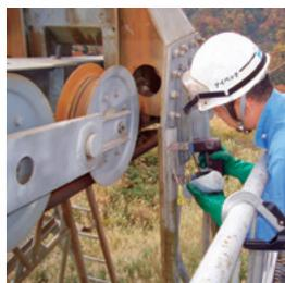
スキリフト搬器磁気探傷試験
