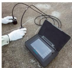
超音波法によるひび割れ測定
