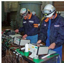
水車ケーシングの動的応力測定
