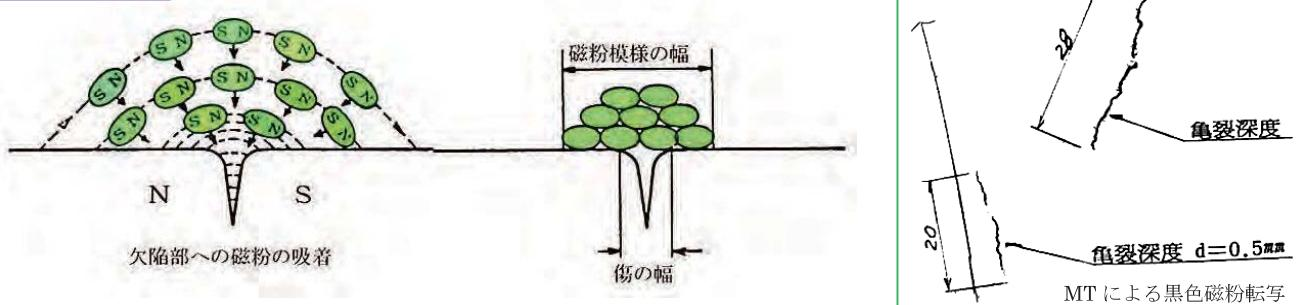
原理：試験材を磁化した場合、試験材の表面又は表面付近に磁束をさえぎるような欠陥があるとき、この部分で磁束が表面に漏洩し、欠陥の表面に磁極が表われる。この部分に一様に分散した微細な鉄粉を振りかけると鉄粉の粒子は、欠陥部に凝集、吸着し、欠陥部に鉄粉の模様ができる。このとき黒色磁粉を用い、その上から紙を当ててその模様を転写すると右の写真のような模様を得ることができる。鉄分に蛍光塗料を塗膜状に付着させておき、その部分に紫外線ランプを照射しながら観察すると欠陥形状を目視することができる。
