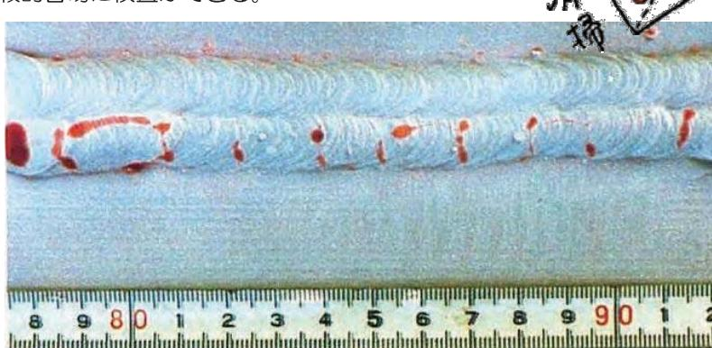
浸透探傷検査による欠陥指示模様(6ページ MT 試験体と同一のもの)
