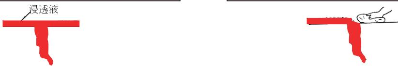
③白色の粉末現像液を試験体表面に塗布すると、傷の中に残留している浸透液は、吸い出されて表面に広がり模様を造る。 ⇒ ④これを観察することにより、微細な傷も肉眼で発見することができる。
