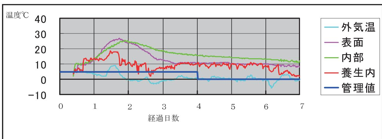
測定方法：①前もってコンクリート内部と外気温計測のために、熱電対を設置しておきデーターロガー及びスキャナーで温度計測を行う。 ②必要な時間温度は、モニターで確認することに加え、所定時間毎のプリントを行う。 ③コンクリート打設時からのデーターはデーターロガー内のHDDに収録する。必要に応じて、パソコンで温度をグラフ化することができる。
