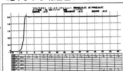
タンクローリー（移動貯蔵タンク）の漏洩検査は、外気温の影響を受けるので温度補正を行う。
