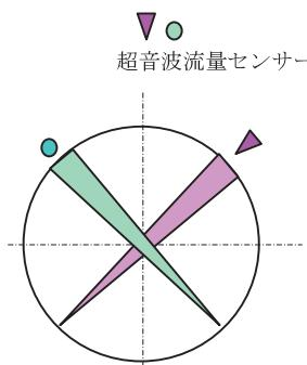
送信信号が配管内の流体の速度により影響を受け、ドップラー効果を用いて受信信号の変化として検出される。その変化値を演算して流速を表示する。
