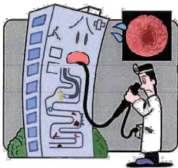
病院での胃の検診で胃カメラが使用されるように、管内の状況等をファイバースコープにより、直接目視しようとする方法。ファイバーの長さは、通常1mから3mがよく用いられるが、6mのものもある。またファイバー径も数ミリと細く細管の観察に向いている。ビデオカメラを用いてモニターしながら内部の状態を写すことができる。最近のファイバースコープは先端にCCDカメラが取り付けられており、明るく広範囲に見ることができ、機種によっては欠陥の位置や面積を計測できるものもある。パイプの内部を奥深く観察したりするためにはパイプカメラを用いる。パイプカメラは普通10m以上の長さがあるので、奥深い部分の状況を観察するのに都合がよい。機種によって水深20m以上の水圧下で撮影できる性能のものや、パイプ内を自走するものもある。
