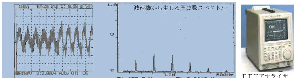
簡易的に設備の振動等を測定して判定する方法がある。
