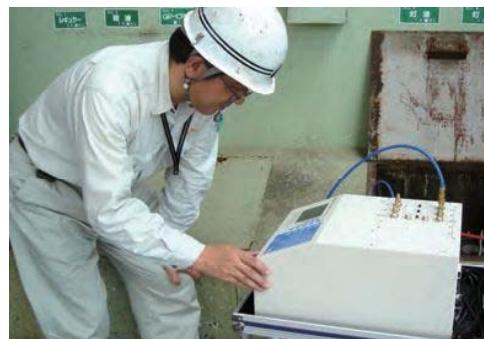
アイペック製タンクリークテスタでの気相部検査
