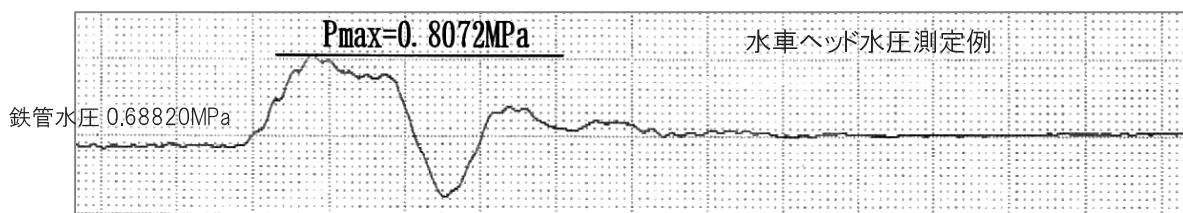
変換器は取り付け前に高性能の圧力校正器で校正したものを用いる。校正器は携帯用重錘式圧力計や電子式の圧力キャリブレーターを使用するが、最近では精度や重量の面で後者が用いられるようになっている。
