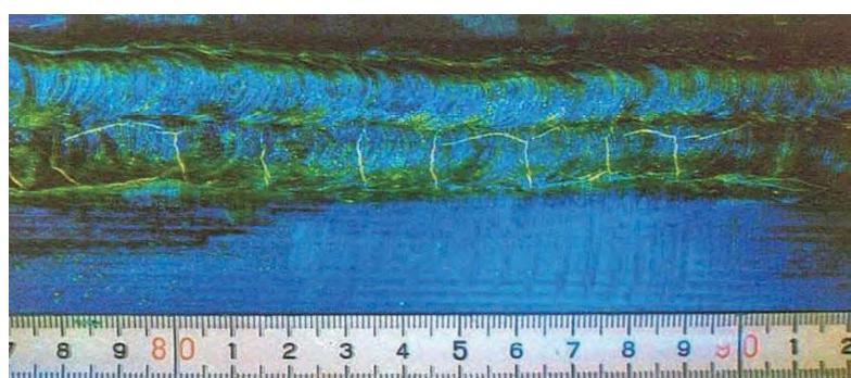
磁粉探傷検査による欠陥指示模様(7ページ PT試験体と同一のもの)
